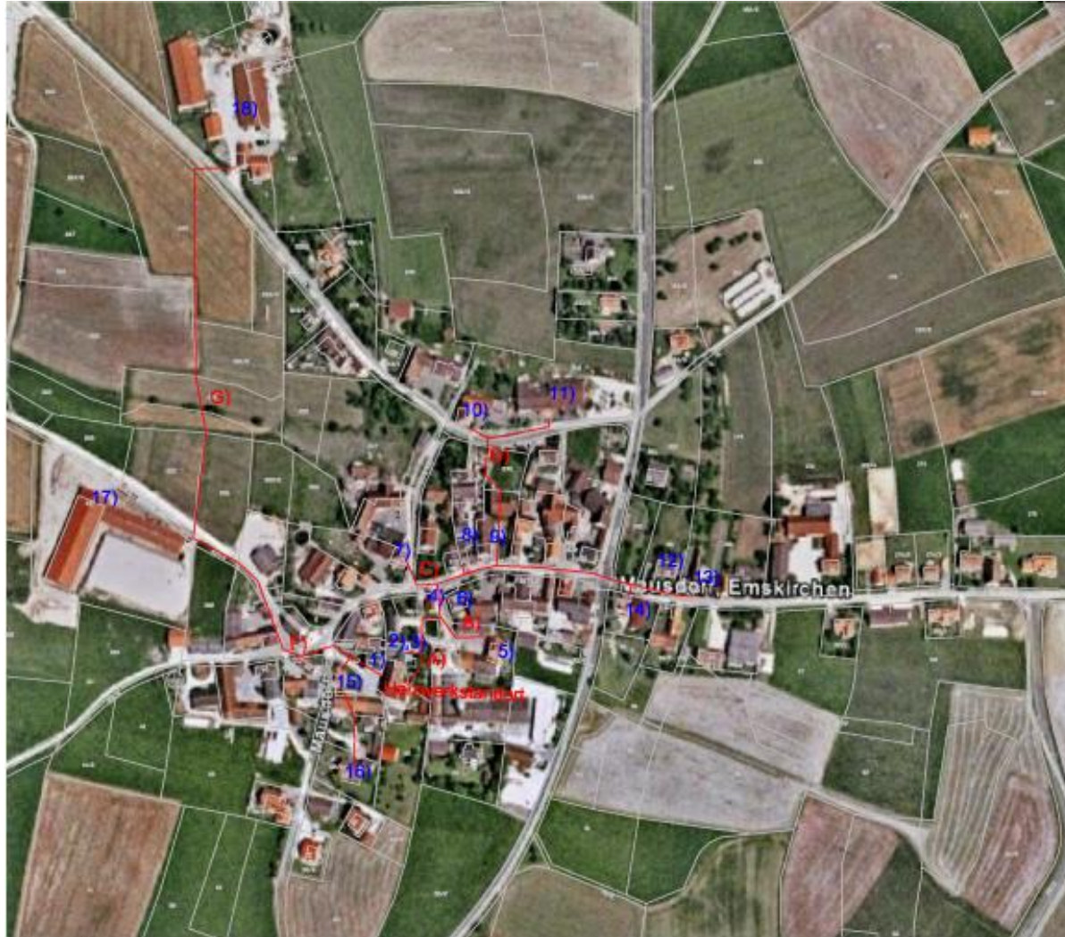
Erste Grobplanung des Wärmenetzes
