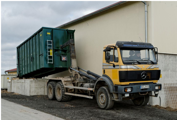
Absetzen des Containers am Heizhaus
